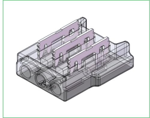
Lötfreier 3-poliger LED Verbinder für 10 mm CCT SMD Streifen. Frei konfigurierbar mit 22 AWG Kabeln. Ohne Kabel. Max. Strom: 4 A.
